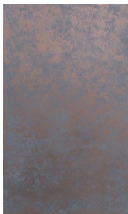
写真1. 主材3 1回目塗装終了時の仕上がり (目安) * 黒皮鉄
