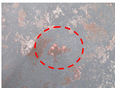
写真2. 樹脂溜まりの例 (このような樹脂溜まりをできるだけ無くす)
