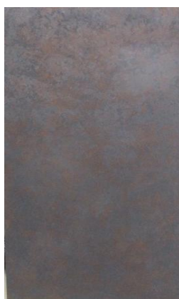
写真4. 主材3 2回目塗装終了時（完成時）の仕上がり（目安）* 黒皮鉄
