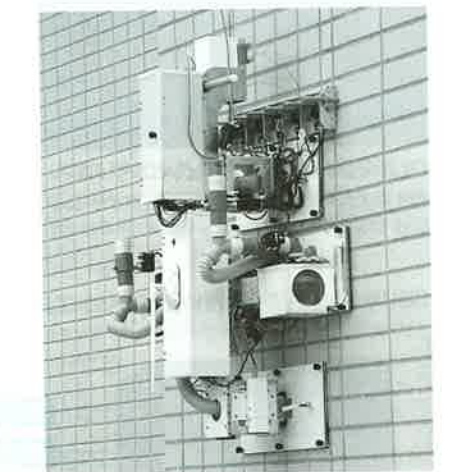
〔写真4〕外壁診断ロボット 吸引ポンプで壁面に吸着しながら、前後左右に移動する(写真:国土技術政策総合研究所)
